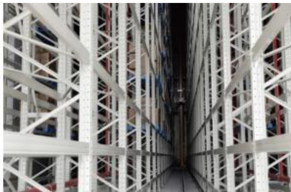
智能立体仓储系统
