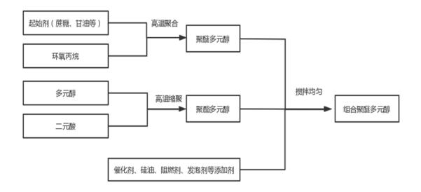
聚醚多元醇为组合聚醚的主要上游原料,形成泡沫骨架,在配方体系中起到关键作用,是由蔗糖、甘油等起始剂与环氧丙烷高温聚合而成的大分子,通过改变起始剂、环氧丙烷比例或者改变加料方式可以得到不同牌号的聚醚,从而应用于组合聚醚不同配方中。
