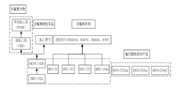
含氟制冷剂生产经过反应、水碱洗、精制等工序制得。主要应用于冰箱、家用空调、汽车空调等制冷领域,还可在聚氨酯行业中用作塑料发泡剂、半导体行业中用作电子清洗剂及精细化工中用作气雾剂等。
