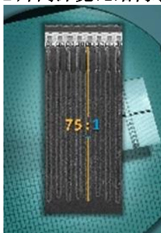
存储芯片高深宽比结构示意图
