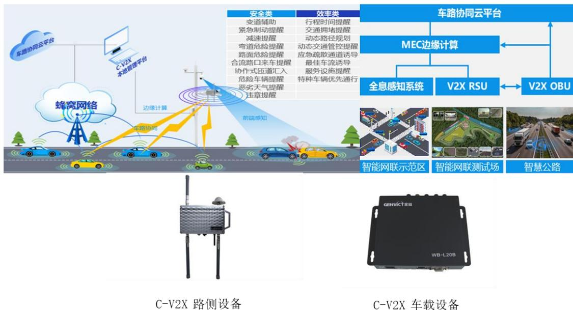
图十一：智能网联车路协同云、端产品
