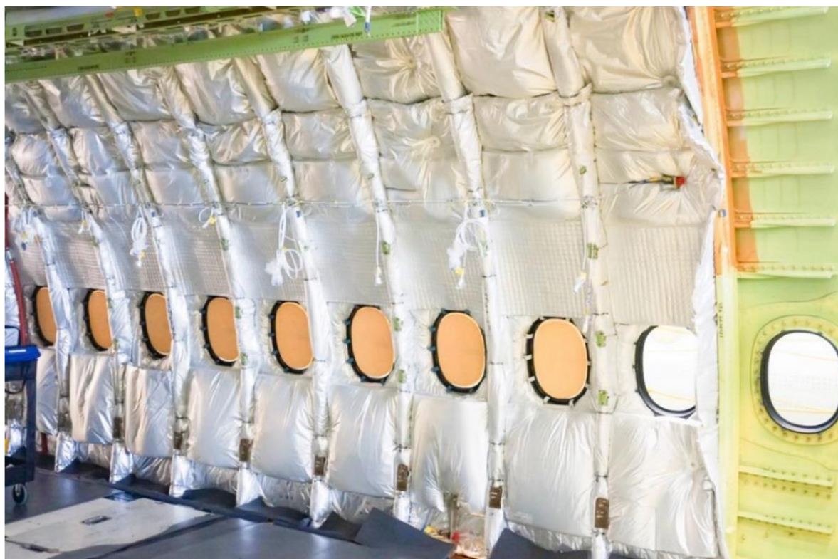
（民航飞机隔音隔热层展示）
