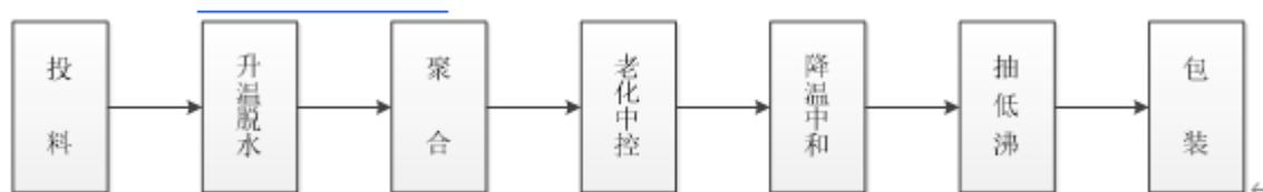
纺织印染助剂系列的工艺流程图：
