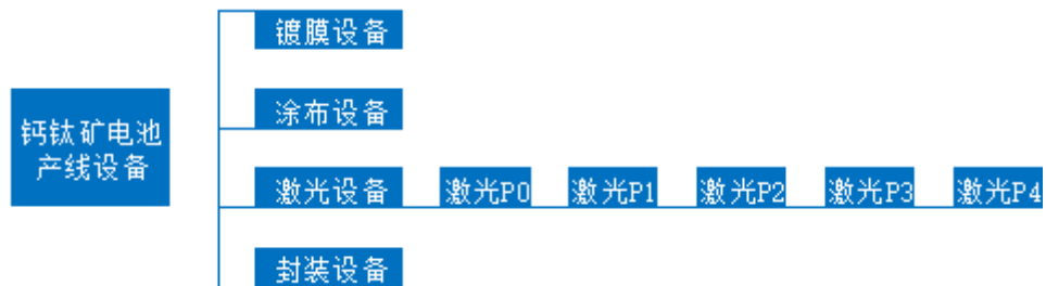
图表 3 激光设备在钙钛矿电池产线设备主要应用环节
