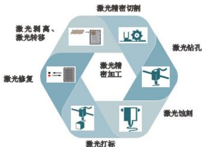
图表 1 激光精密加工设备的加工方式
