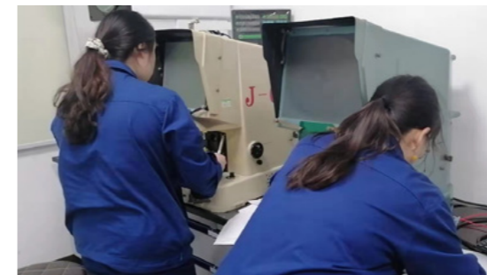
▲ 绝缘厚度测量实操练习
