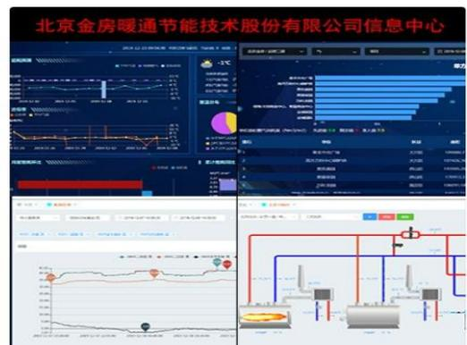
用我公司自主研发并拥有专利的设备进行监视和控制，关注采集量的变化趋势和设备状态，实现与中心监控平台的数据通信。利用我公司的热联无人监控系统可实现对换热站、供热管道的远程监控，脱离供热的老旧管理模式，提高工作效率，保证供热厂站的正常运行，供热管道的正常传输，提高管理水平和社会效益，提升居民的满意度。
