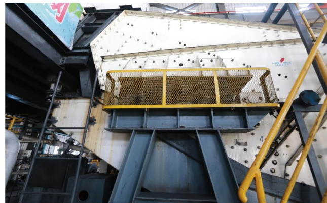
脱节筛采用减振器减振降噪
