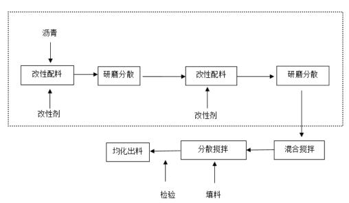
②预浸油配制工艺流程图
