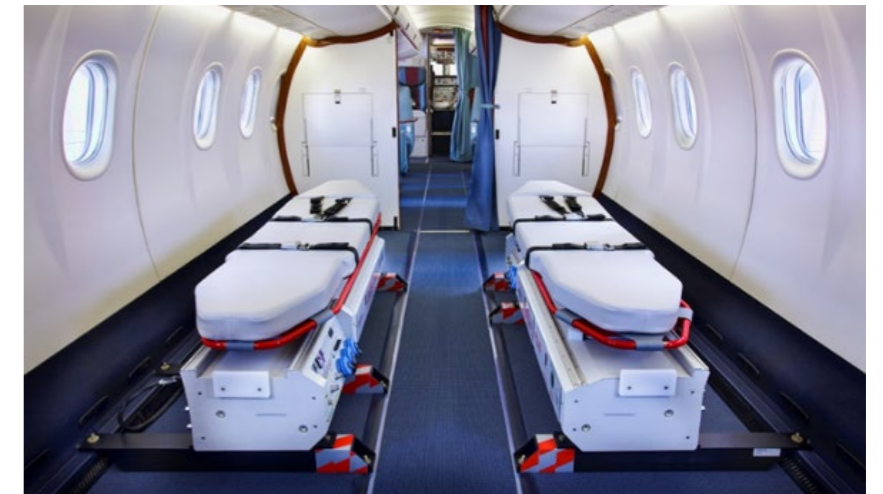
AVMAX 工程部对各类产品和 STC 证书实施严格测试，确保安全性及符合行业标准，图为医疗后送型飞机改装
