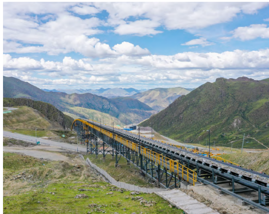
巨龍銅業的長距離下坡回流充電式運礦皮帶
