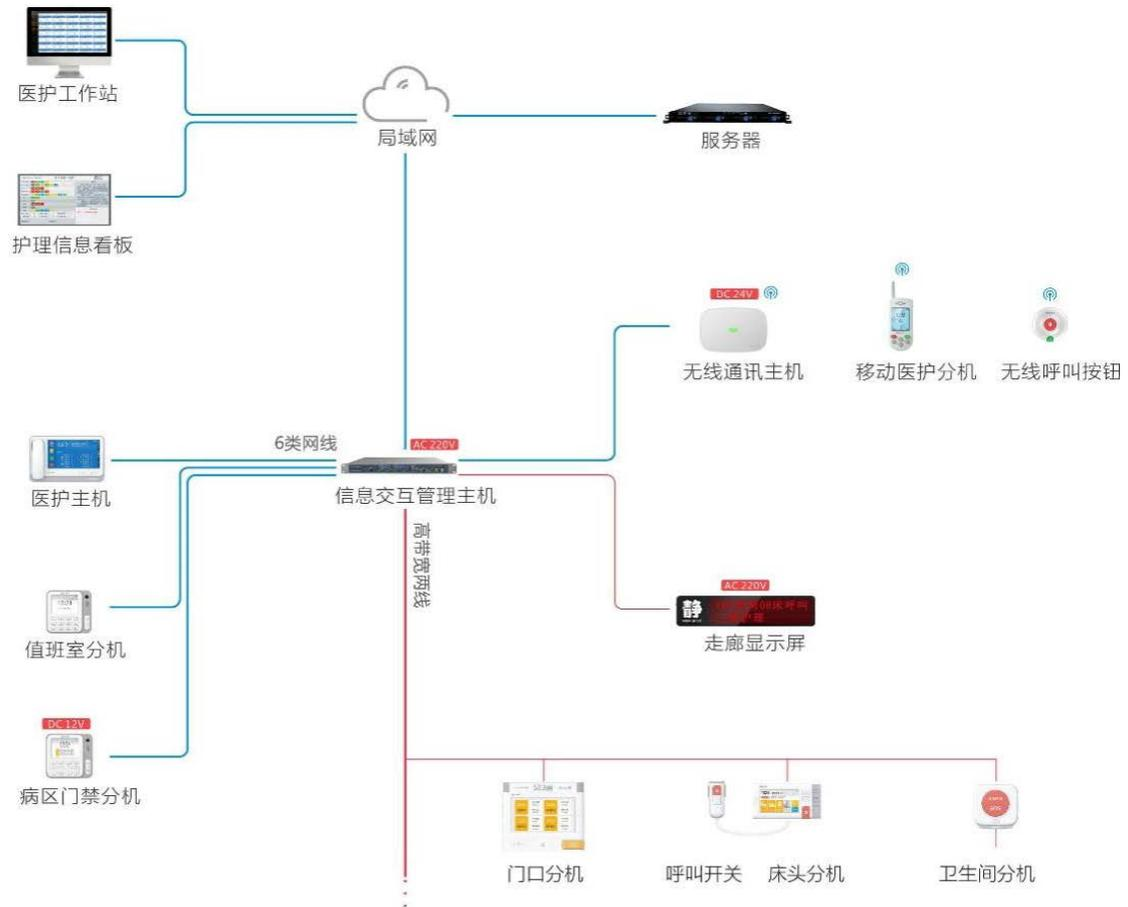
二代病房交互系统应用微服务架构软件设计，各服务独立运行，各项功能互相合作且互不影响，提升了系统的稳定性。二代病房交互系统采用 C/S 及 B/S 双体系架构作为系统开发基础，运用公司自主研发的组件化医护通讯控制台技术等核心技术，使之能够与 HIS 系统无缝对接，从 HIS 系统中调取患者相关信息，通过信息与设备的结合，优化临床业务流程，对加强病房管理、减轻医护工作强度具有重要意义。二代病房交互系统的软件业务架构如下图所示：
