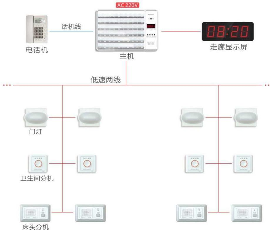
一代病房交互系统应用两线制组网技术，具备了传输速度快、抗干扰性强、容错率高的特点，同时采用了独特的音频信号处理电路，使得呼叫通话、广播音质清晰，失真率低，可完全替代广播系统。但一代病房交互系统连接较为封闭，功能相对单一。
