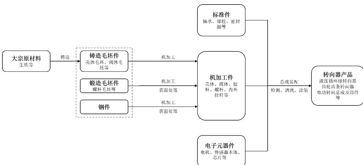
公司所生产的转向器产品主要由机加工件、标准件、电子元器件等零部件经过总成装配、检测、清洗、涂装等步骤后生产而成。其中，对于标准件、电子元器件，公司主要通过向供应商采购获取；对于机加工件，公司则主要通过直接采购毛坯件并自行或委外完成机加工、表面处理等工序获取，辅以通过采购生铁等大宗原材料并自行完成铸造、机加工、表面处理等工序获取。
