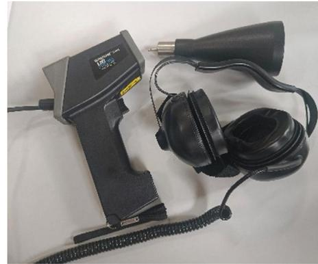
在郑州园区，通过使用压缩空气超声波检漏设备，平均每个漏点一年可节省 5,000 元。
