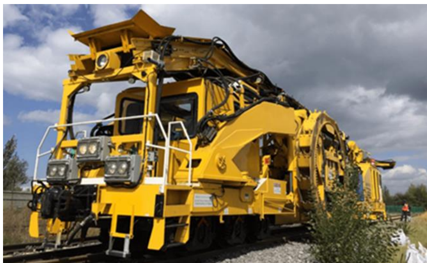
图3-15 哈斯科G04S-III-CN型道岔清筛车
