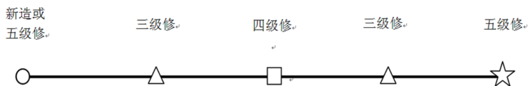
图 3-10 动车组高级检修周期循环图
