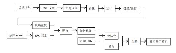
注:平面盖板的触控显示模组工艺流程图无热弯成型这一工艺流程,其余流程均与上述流程一致。
