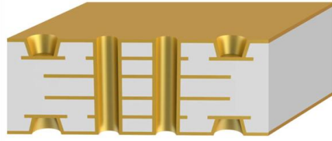
化学沉铜后 (孔壁绝缘基材覆盖铜)
