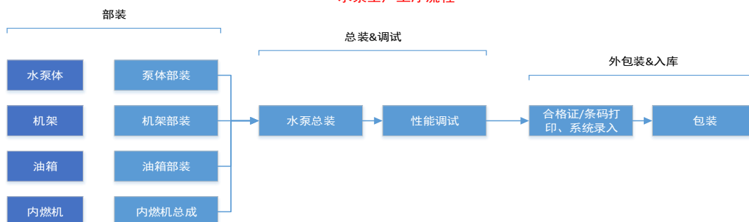
水泵生产工序流程
