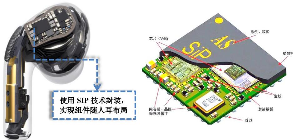
倒装/焊线类是系统级封装的主流技术方式。系统级封装实现的路径包括倒装/焊线类、扇出式以及嵌入式等多种方式，其中倒装/焊线类系统级封装占据主要市场份额。根据 Yole 预测数据，2019 年倒装/焊线类系统级封装产品市场规模为 122.39 亿美元，占整个系统级封装市场超过 90%，预计到 2025 年倒装/焊线类系统级封装仍是系统级封装主流产品，市场规模将增至 171.7 亿美元。未来随着市场对于封装产品短小轻薄特征的需求不断增长和 SiP 系统级封装技术的进步，系统级封装将迎来广阔的市场空间。
