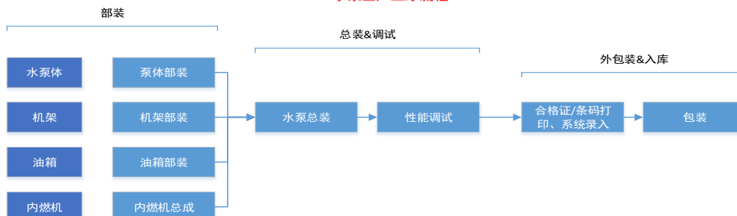
水泵生产工序流程
