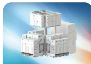
Primo SSC AD-RIE® 26 到 5 纳米及更先进刻蚀
