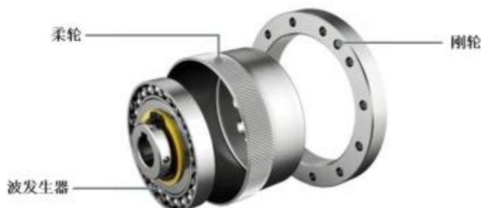
谐波减速器结构示意图
