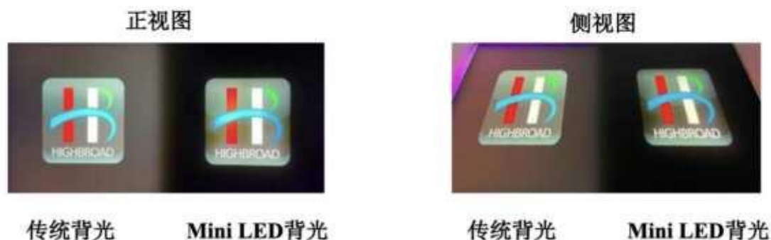
图：Mini LED 背光与传统 LED 背光显示效果对比图
