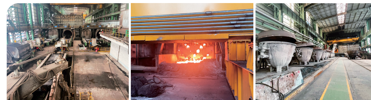
钢渣辊压+有压热闷处理产线
