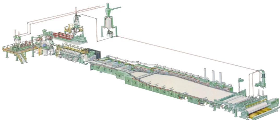
发行人采用平膜法分步拉伸工艺，具有设备稳定、生产效率高的优势。
