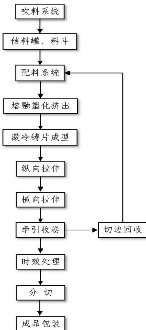
公司功能薄膜生产线由配料系统、挤出系统、纵拉系统、横拉系统和收卷系统组成，总长度约 130 米，膜卷最大宽幅为 8.7 米。具体示意图如下：
