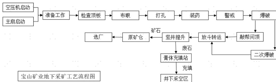
针对地下矿体的结构参数的不同，标的公司主要采用上向水平分层充填采矿法和机械化盘区上向进路充填法进行开采，两者在采场长度、宽度、矿石贫化率、采场生产能力、采掘比、出矿功效等方面有所差异。
