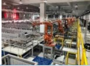
在工业机器人的基础上，应用智能传感、机器视觉等先进技术，配以定制化末端执行器，输送机及周边装备及系统，实现物料拆码垛、分拣、搬运等不同功能，可实现盲拆、混码、混拣等特殊功能。
