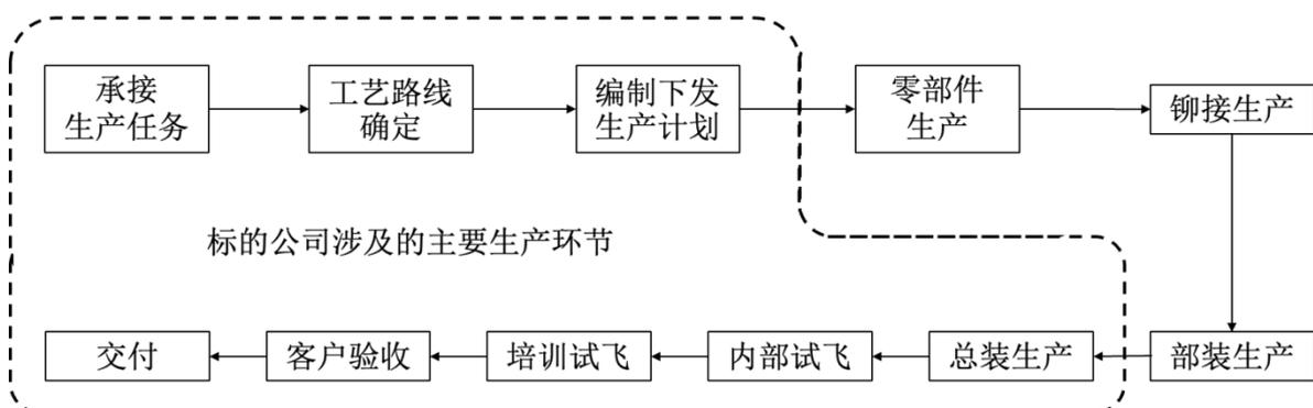
如上图，上市公司主要从事零部件生产、铆接生产和部装生产，标的公司自上市公司采购零部件，并继续进行总装生产等后续工序，共同组成直升机生产的关键核心环节。
