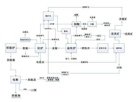
精矿仓按配料指令对铜精矿等原料用行车进行抓配混合,再通过行车抓取混合铜精矿等原料以及其他辅料,由皮带传送至底吹炉熔炼。
