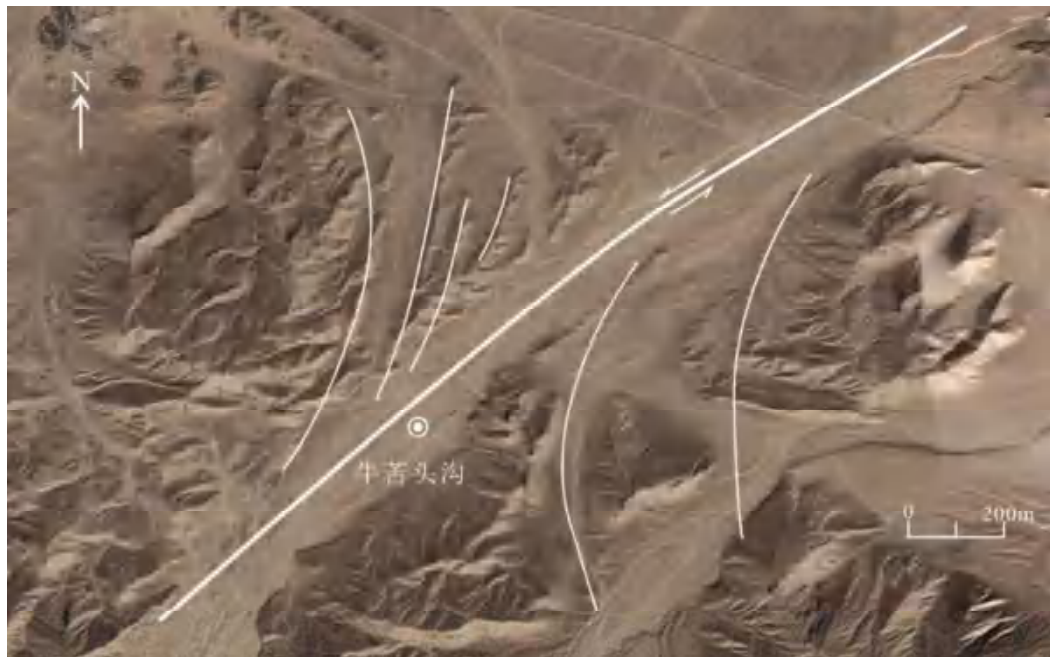
图 3-5 牛苦头沟断裂 (NE 向) 西侧存在拖拽构造
