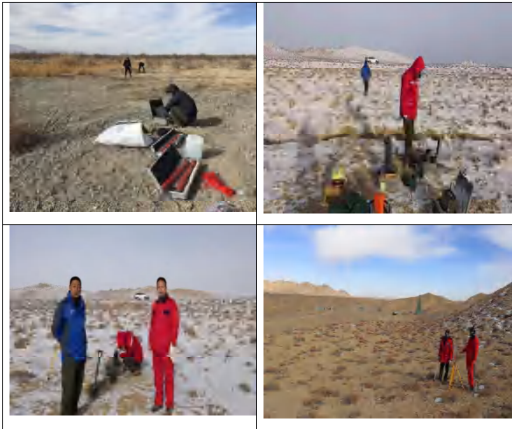
图 8-16 音频大地电磁测深仪器数据采集
