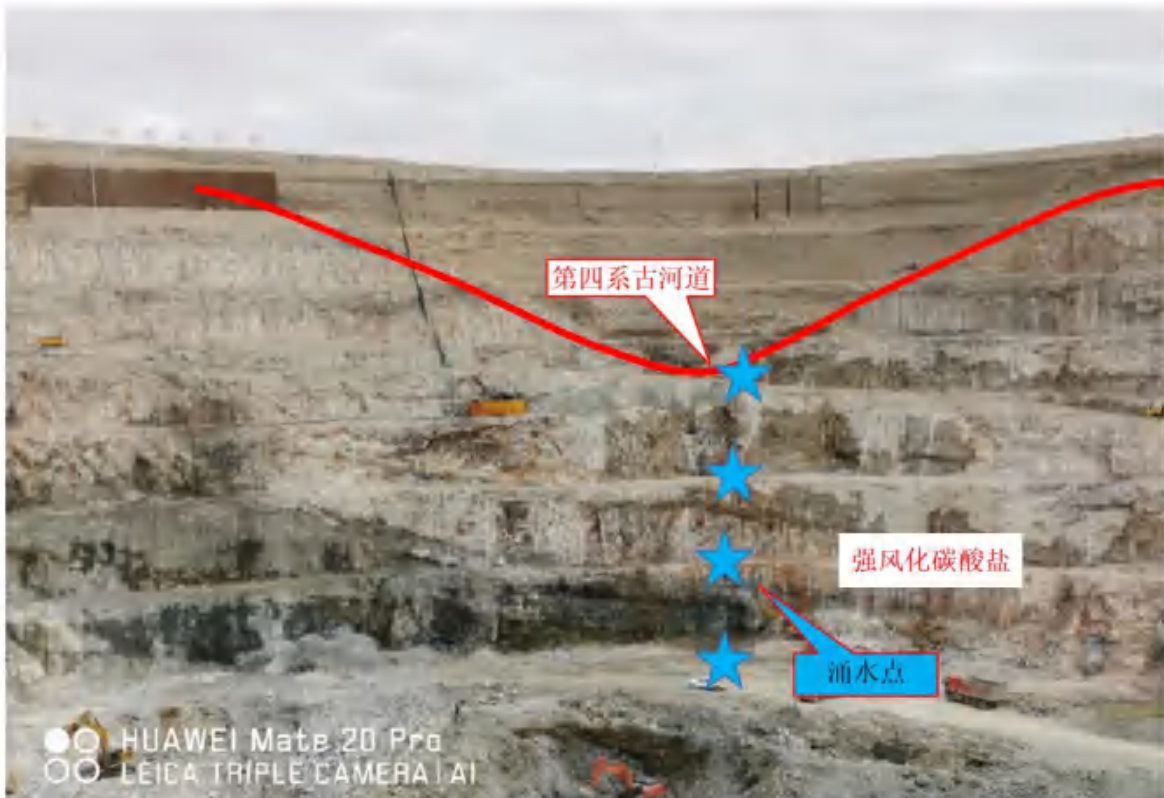
图 1-13 北侧（下游古河道）第四系砂砾石层及下伏大理岩破碎带的涌水现象
