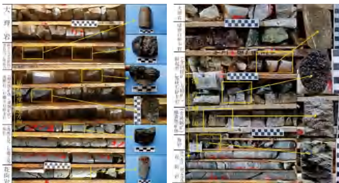
图 3-2 牛苦头 M1 ZK0103 钻孔中蚀变分带
