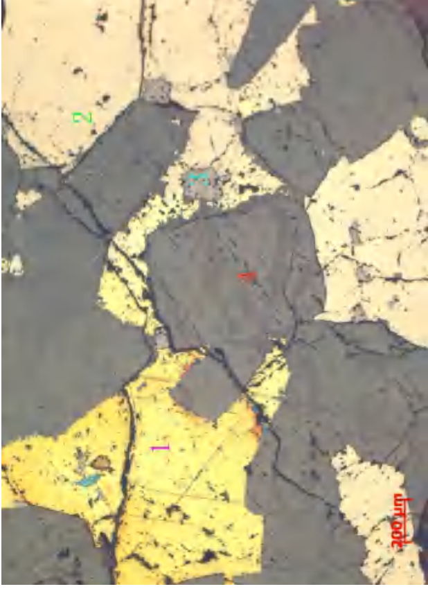
照片 18 (50×反)黄铜矿交代磁黄铁矿、磁铁矿被磁黄铁矿交代 1-黄铜矿, 2-磁黄铁矿, 3-磁铁矿, 4-黑柱石
