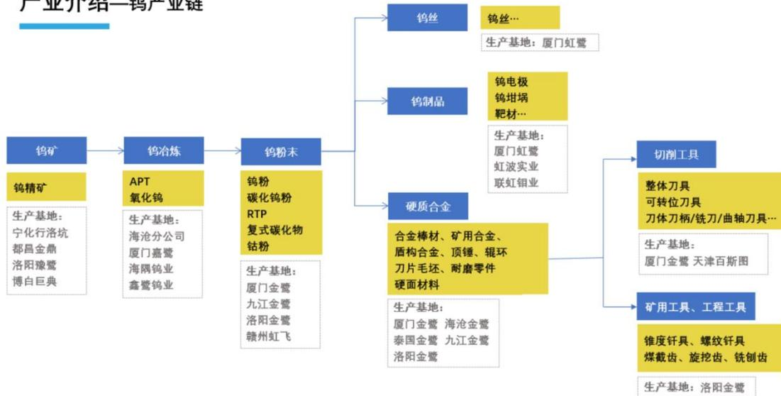
钨产品方面，公司充分发挥自身独特的冶炼加工技术优势和深厚的丝材制造技术实力，融合国际先进粉末制造技术，以钨矿为原料生产出性能优异的钨酸铵、钨粉、钨坯、钨丝以及钨坩埚等钨制品。公司的钨产品广泛应用于电光源、电真空、半导体、光电子、机械加工等领域。公司的钨产业布局和产品具体如下：
