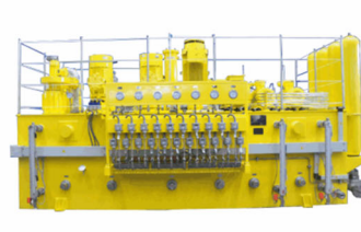
特高压调相机油系统
