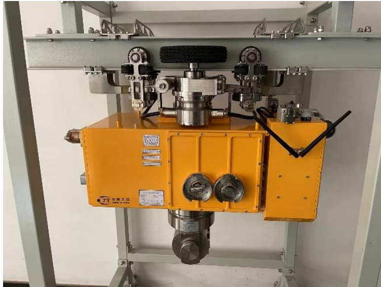
图 37、防爆式轨道智能巡检机器人
