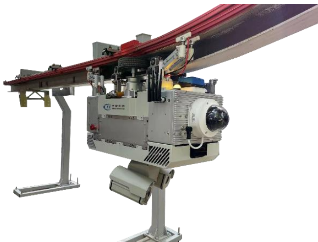
图 35、极寒轨道式智能巡检机器人
