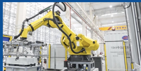
储能数字化工厂自动入箱产线
