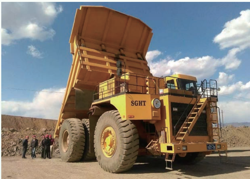
含钕高强 NM450 钢和 Q690 高强钢制造的减重 15% 的首钢矿车厂 150 吨矿用自卸车
