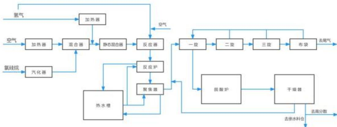
气相法白炭黑主要是通过化学气相沉积法，又称热解法、干法或燃烧法制得。其原料一般为四氯化硅、空气和氢气，空气和氢气分别经过冷却脱水、硅胶干燥、除尘过滤后送入合成水解炉。将四氯化硅原料送至蒸发器中加热蒸发，并以干燥、过滤后的空气为载体，送至合成水解炉。四氯化硅在高温下气化后，与一定量的氢和空气在高温下进行水解；此时生成的气相法白炭黑颗粒极细，与气体形成气溶胶，不易捕集，故使其先在聚集器中聚集成较大颗粒，然后经旋风分离器收集，再送入脱酸炉，用水蒸气和空气吹洗气相法白炭黑至 pH 值为 3.8 以上即为亲水白炭黑，用有机基团取代白炭黑表面羟基中氢使白炭黑能够溶于有机溶剂即为疏水气相法白炭黑。
