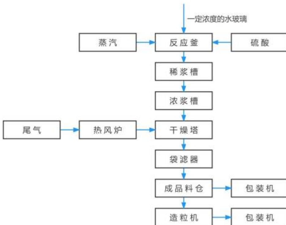
沉淀法白炭黑利用硅酸钠与硫酸反应制得，液体水玻璃加水调节到 20%—30% 的浓度送入下一道工序进行合成，在合成釜内先加入一定量的水和水玻璃，在 80-90℃ 温度下，同时加入硫酸和水玻璃并搅拌而生成白炭黑浆料，将浆料进入压滤机进行压滤，并用清水洗去其中的硫酸钠再进入打浆槽制得浓浆，用炭黑尾气燃烧产生的烟气与空气热交换，得到 500℃ 左右热风将经过雾化机雾化浓浆干燥为白炭黑粉末，用袋滤器收集后进行包装，根据需求，可将粉末状的白炭黑进行造粒，变成块状白炭黑进行包装销售。
