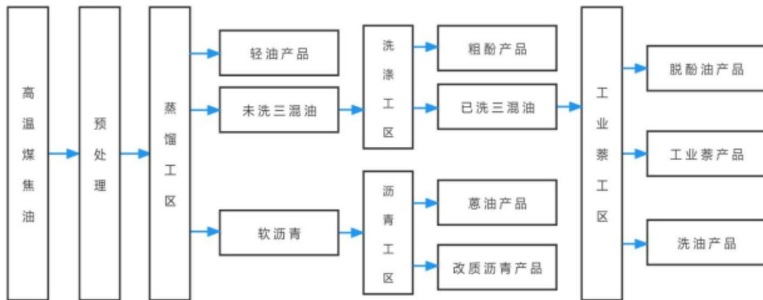
高温煤焦油是焦化工业的重要产品之一，其组分极为复杂。该工艺利用焦油中各组分沸点不同的性质，通过塔式常、减压蒸馏工艺分离出不同产品。
