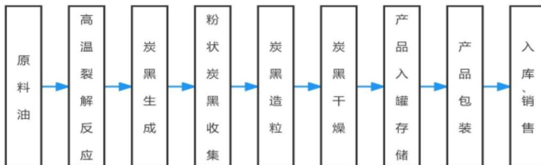
炭黑反应生成过程炭黑生产的核心是炭黑反应炉，燃料与空气先在反应炉的燃烧室完全燃烧产生高温烟气，并高速流经喉管。在喉管处，原料油由喷枪喷入反应炉，高温裂解反应生成炭黑及尾气。在此过程中，通过控制风、油配比、添加剂和急冷装置来控制生成炭黑品种。炭黑反应生成过程的关键技术是反应的温度、时间及取向控制。反应温度的高低及反应时间的长短主要影响炭黑的性质，反应的取向决定原料油生成炭黑反应转化比例的高低。
