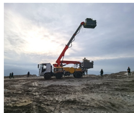
BCHM 型现场混装乳化炸药车
