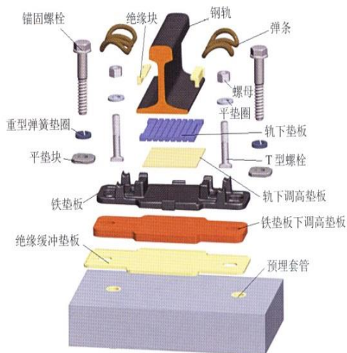
WJ-7型扣件组装零件图
