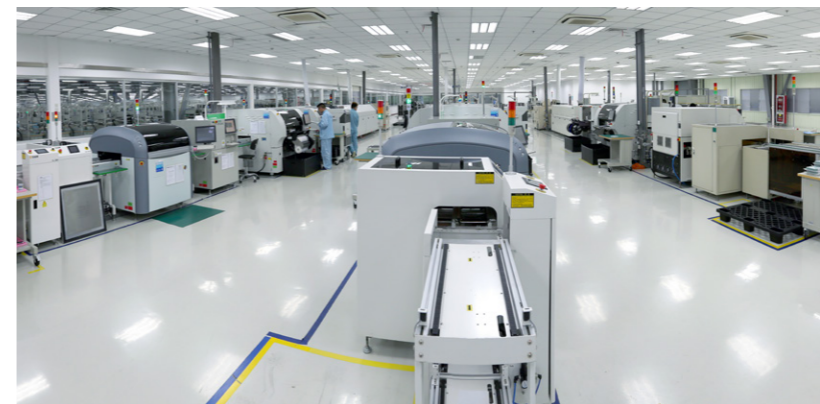
无铅智能化表贴生产线
