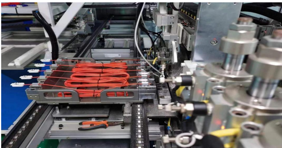
图十三 工业电子雷管自动化生产线
