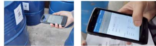
▲ 利用MOM系统现场作业, 扫码录入入库信息
