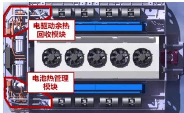
余热回收整车热管理系统
