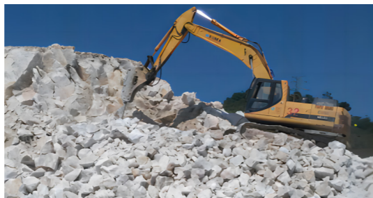
采用矿石破碎解小，降低废石混入率，提高产品质量
