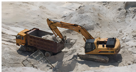
利用自制筛网，降低硬质矿石粉状混入率，提高产品质量
