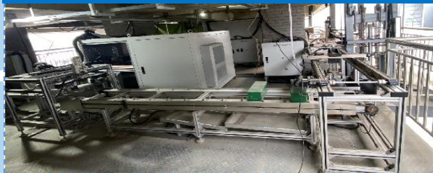
混凝土自动取样、成型装备 在眉山厂进行组装中试
