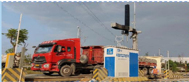
骨料进场取样、检测智能装备 在眉山厂中试运行300余次
