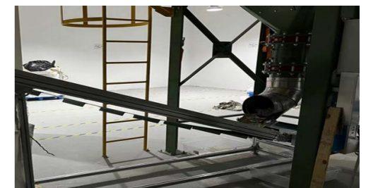
改用自动排料机，减少因排料造成的停机停产问题，提升产能
